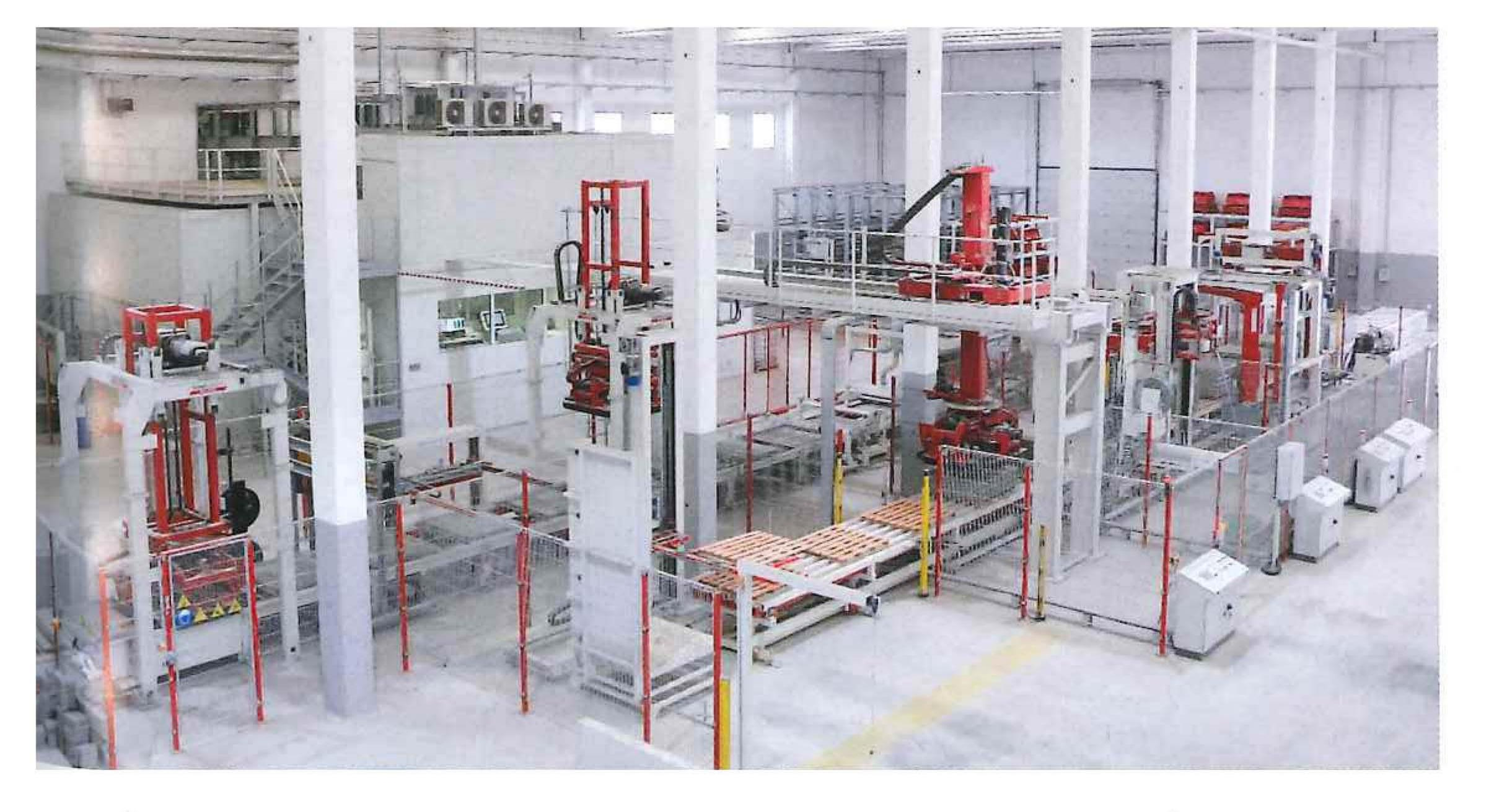
Imballaggio sulla linea del secco in Siprem: accostatore, doppiatore di blocchi e impacchettatrice
